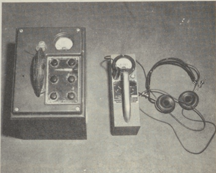
A--Ion Chamber B--Geiger Counter
