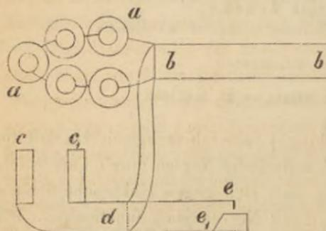
Zusammengestellt wurde der Versuch in folgender Weise: Von der Kette *aa* gingen Leitungsdräthe zu dem du Bois'schen Rheochord *bb* und von hier zu den amalgamirten Zinkelektroden *cc*<sub>1</sub>, welche, auf einer Glastafel befestigt, dem Frosche so untergeschoben wurden, daß er mit den
